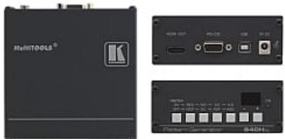
Le 840HxI est un générateur de mires HDMI haute performance. Il génère 32 mires avec 16 résolutions d'ordinateurs, HD et 7 résolutions configurables. Il inclut plusieurs mires qui incorporent le mouvement
