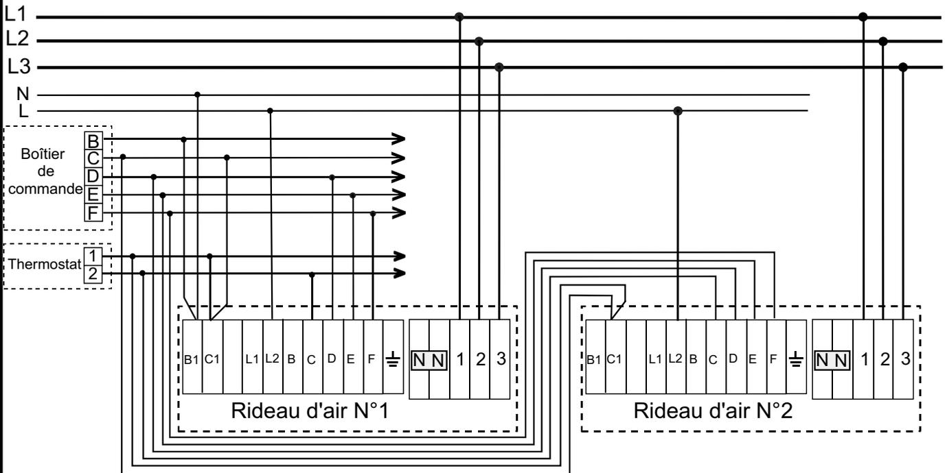
*Si l'on utilise pas de thermostat, il suffit de rejoindre la borne L2 du rideau d'air à la phase d'alimentation L, et la borne B du boîtier de commande au neutre.*
