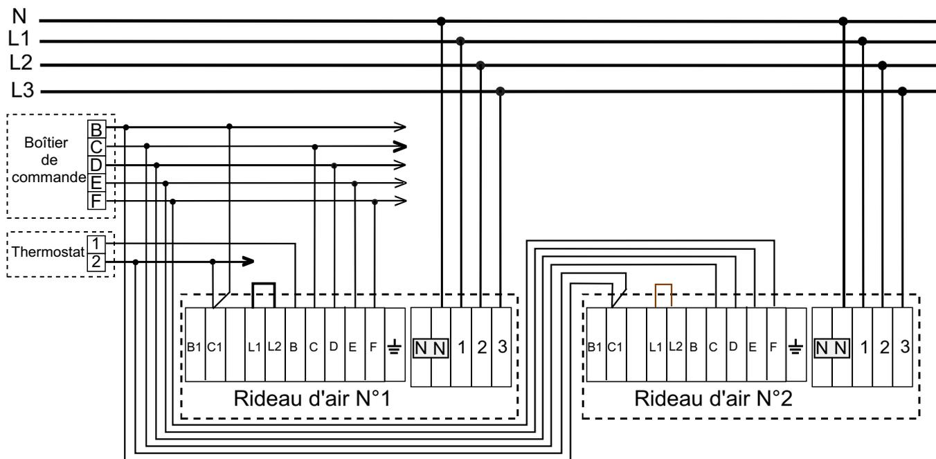
Si l'on utilise pas de thermostat, il suffit de rejoindre la borne B du rideau d'air à la borne B du boîtier
