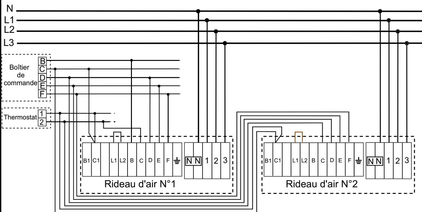
Si l'on utilise pas de thermostat, il suffit de rejoindre la borne C du rideau d'air à la borne C du boîtier
